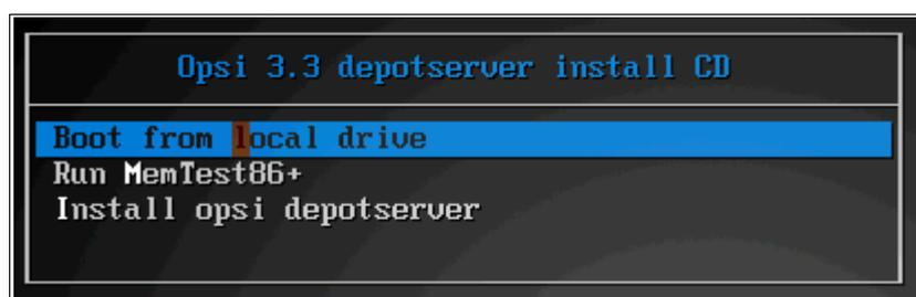
Nach einigen Sekunden Wartezeit wird 'Boot from local drive' automatisch ausgewählt und von der Festplatte gebootet. Wählen Sie 'Install opsi depotserver'.
