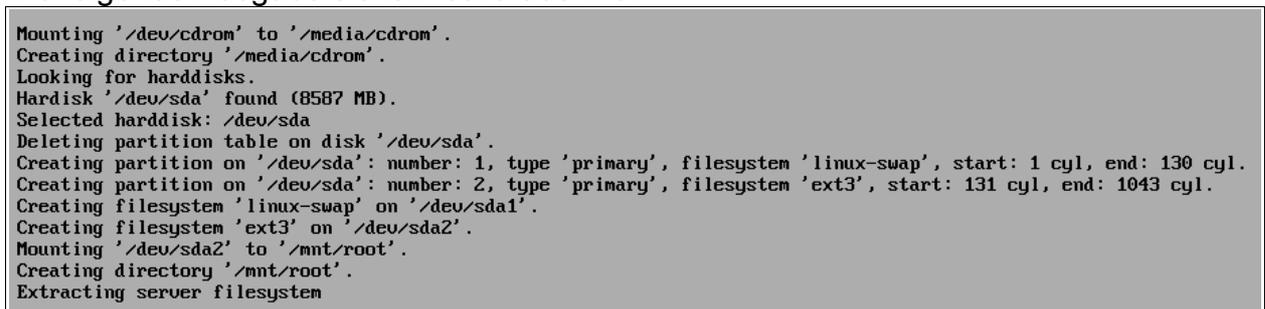
Das 'Extracting server filesystem' dauert eine Weile (5 - 15 Minuten). Nach dem Auspacken des Filesystems wird der Master Boot Record geschrieben und die Maschine rebootet.
